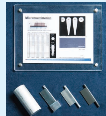
◀写真2 アルミ材料から部品を削り出し、表面処理を施すまで複数の企業が工程に携わる。完成した部品については、各部分の表面処理の厚みを都産技研で計測。
