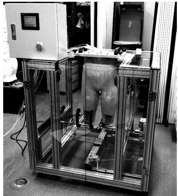
図 3. 動作装置内へ着衣した柔らかダミーを取り付けた状態（動作ダミー）
